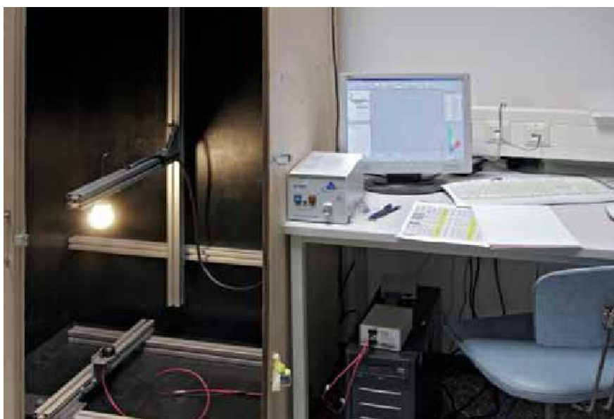
Světelné vlastnosti zdrojů světla jsou laboratorně měřeny a zaznamenávány.
