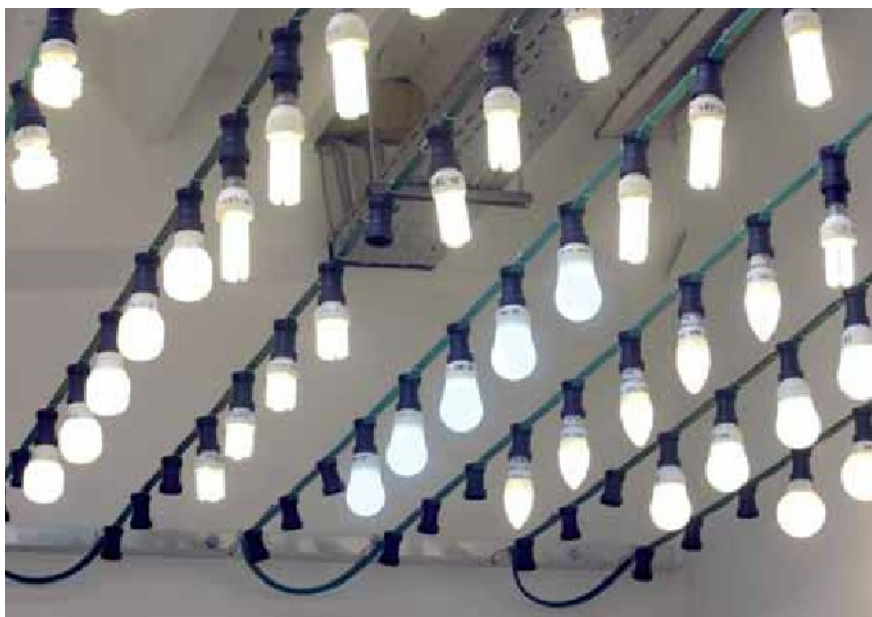
Životnost úsporných zářivek byla testována po dobu 5000 hodin.
